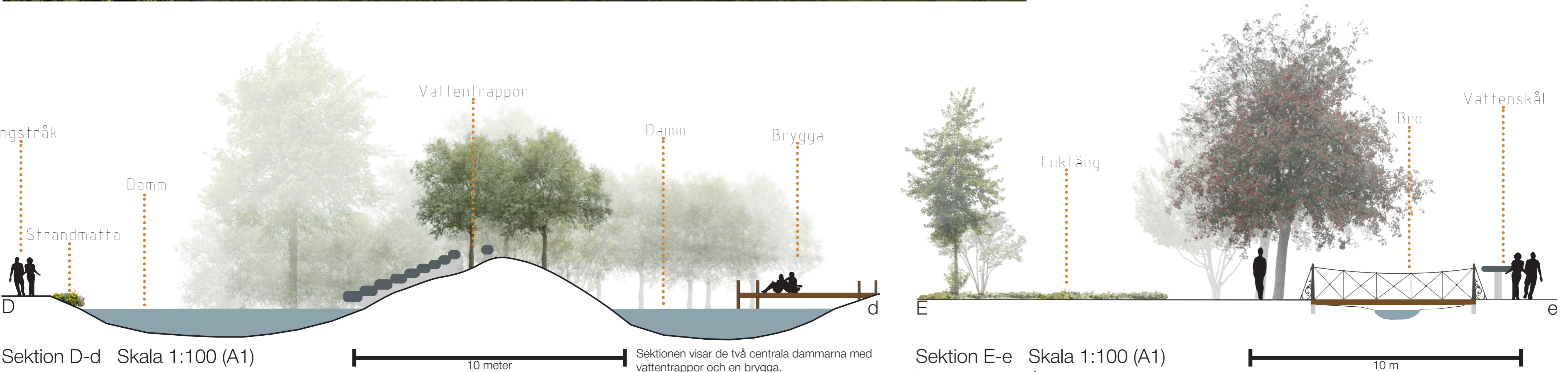
Sektionen visar bron från de södra dammarna över till de centrala dammarna samt vattensköålen som ger ljud och rörelse till vattnet.
