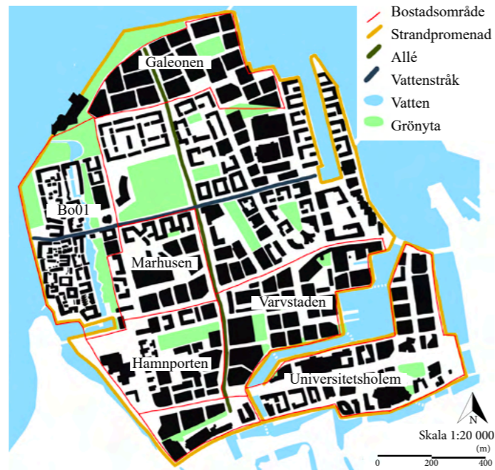
Figur 24. Övergripande illustrationsplan över hela Västra hamnen som framförallt visar på mängden grönytor och var den sammanhängande strandpromenaden är planerad.
