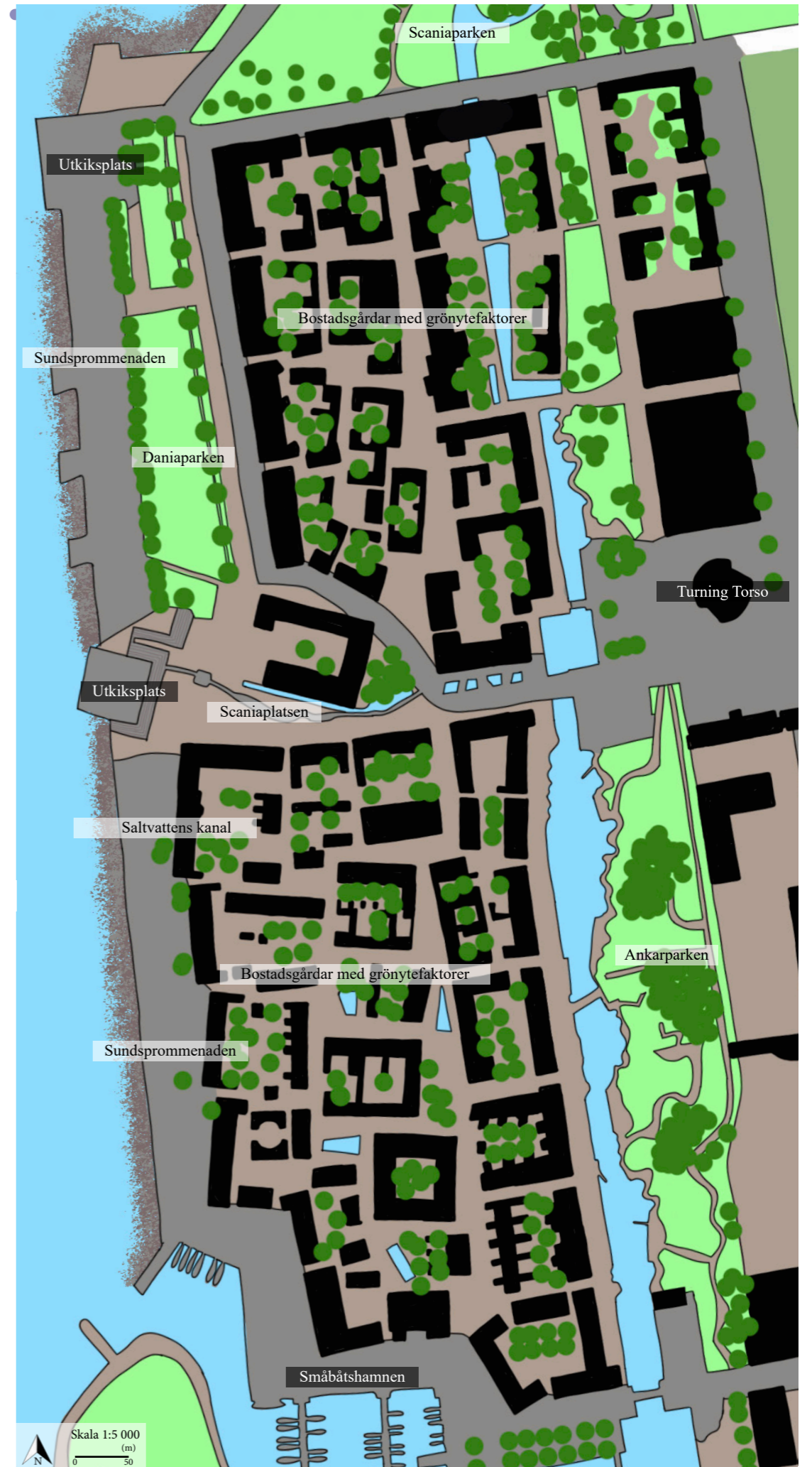
Figur 25. Detaljerad illustrationsplan över Bo01. Byggnaderna är placerade i ett "rörigt" rutnät för att bryta av vinden så att framförallt parkerna, innergårdarna och huvudgatan skyddas från vinden i största möjliga mån. Vad som går att se på illustrationen är att det finns betydligt mer hårdgjorda ytor och att de grönytor som finns är placerade runt om vatten. I de texter där Malmö stad (2023) beskriver projektet verkar de hårdgjorda ytorna vara relativt tomma.
