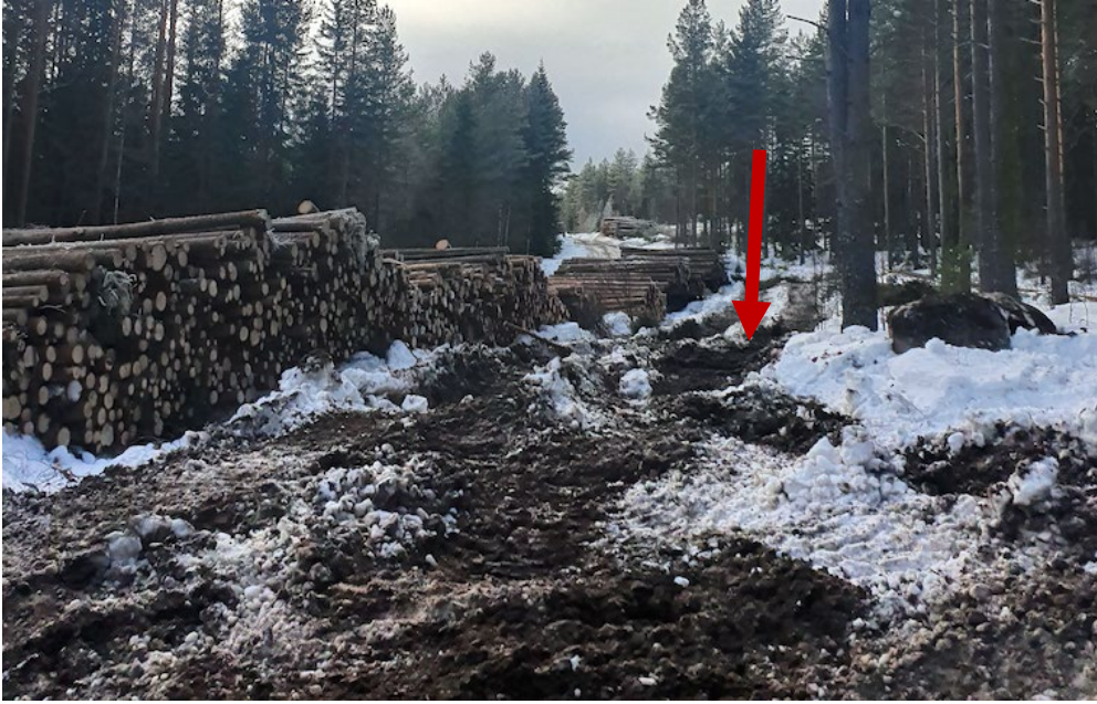
Figur 7. Bild av det enkelsidiga avlägget efter ungefär 20 lass, pilen indikerar var djupaste körskadan uppstått.
