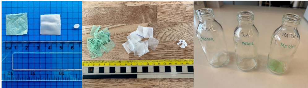
Figur 13. Till vänster; storleken på plastbitarna som användes i experimentet. I mitten; antalet bitar av varje plast som tillsattes i varje experimentflaska. Höger; 250 ml flaskorna med plastbitar.
