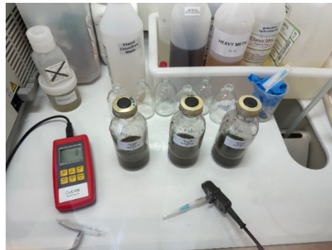
Figur 19. a) vialflaska för gasprov. b) Röd tryckmätare och flaskor i dragskåpet.
