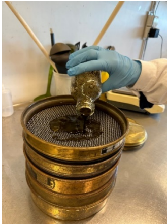
Figur 20. 3 silar, med minskande mått nedåt i silnäten, staplade på varandra.
