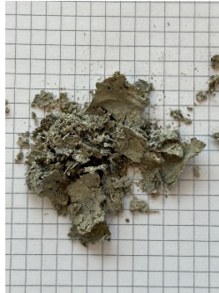
Figur 18 Aska som blir kvar efter att provet varit i ugnen 550° C.
