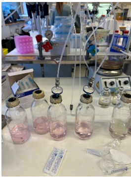
Figur9. a) .Flaskor med medium under flushning av N2. b) mikrofiltrets storlek c) mikrofiltret monterat på flaskan för flushning med N2.
