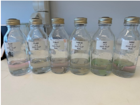
Figur 8. 250ml Flaskor har fyllts med 72 ml basalmedium. (Se recept för W1 och W2). Butylgummipropp och aluminiumring (lock) satts på.
