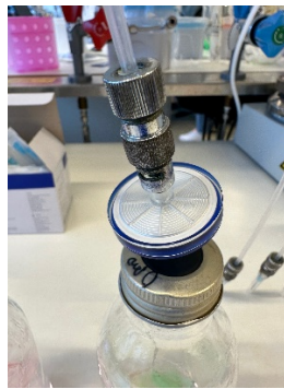
Figur9. a) .Flaskor med medium under flushning av N2. b) mikrofiltrets storlek c) mikrofiltret monterat på flaskan för flushning med N2.
