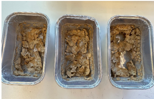
Figur 18 Aska som blir kvar efter att provet varit i ugnen 550° C.
