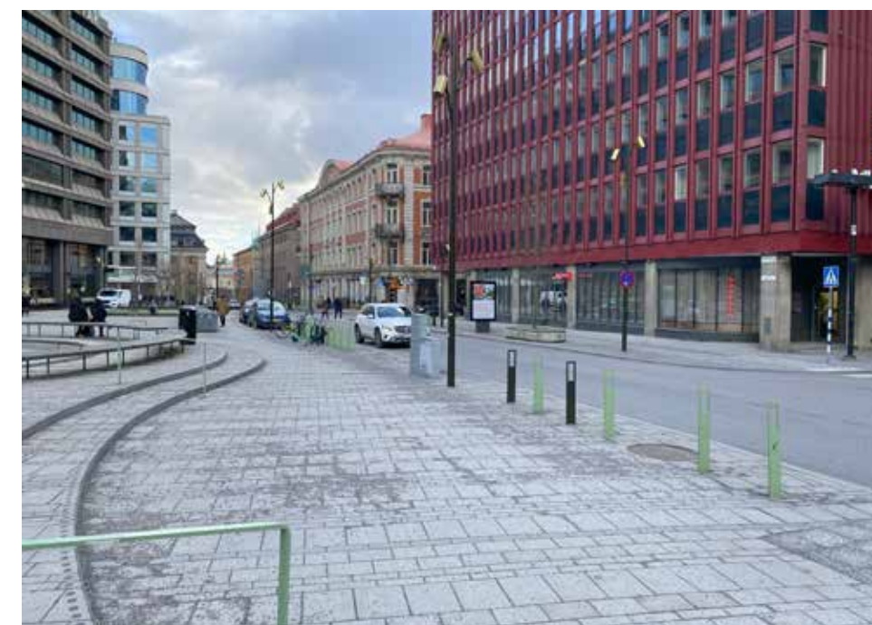
Figur 84: Torgets cykelparkeringar är placerade i torgets kantzoner mot bilgatan där de även får funktion som pollare.
