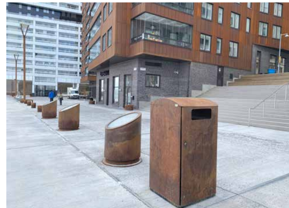
Figur 96: Sammanhållen design längs stråket med materialval som även kopplade an till byggnadernas material. Valet av cortenstål som material resulterar i ett visuellt uttryck med däremot förhindrar att kunna nyttjas som till exempelvis sittplats.
