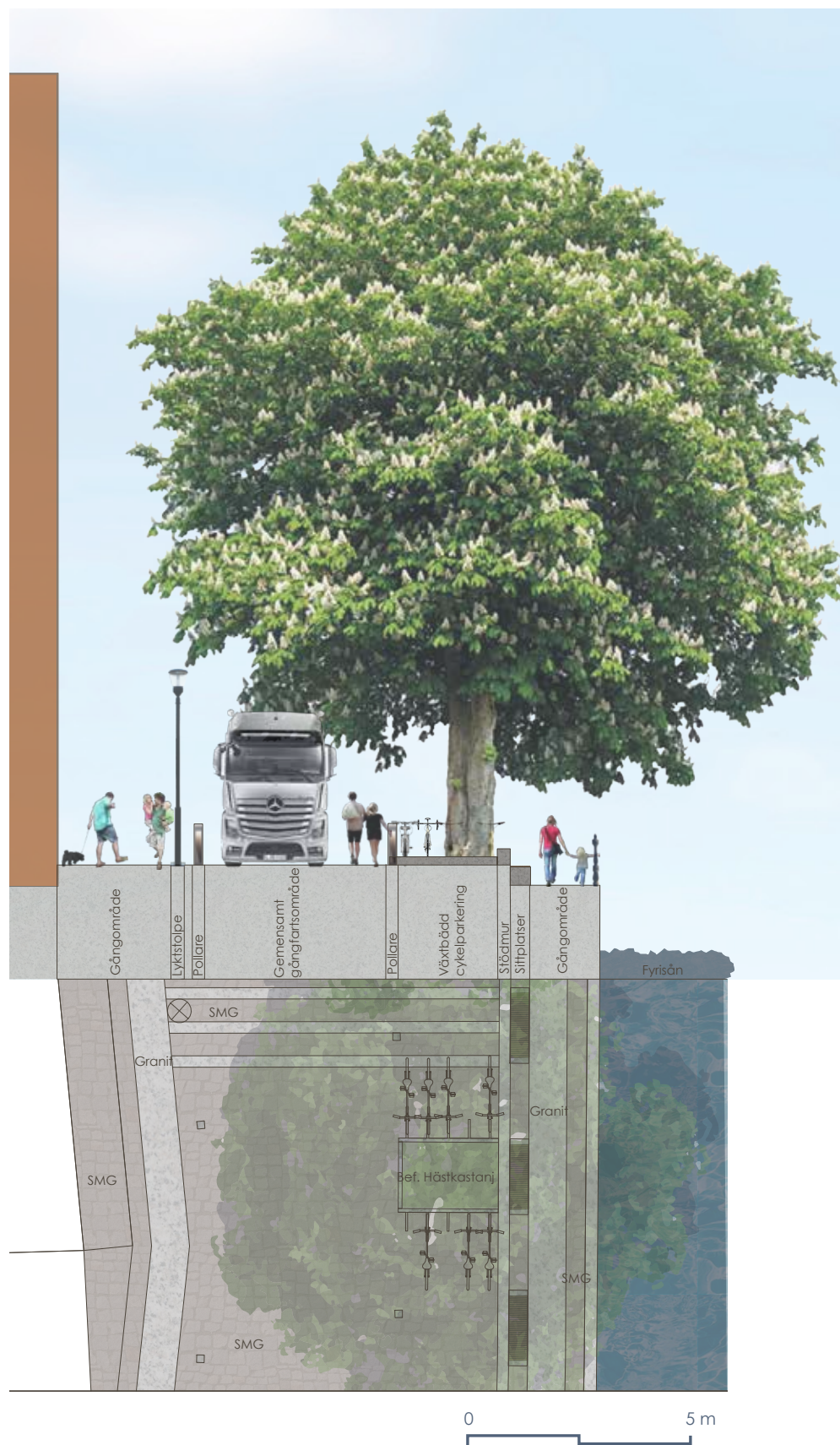
Figur 114: Tvärsnitt TB-tb, genom Västra Ågatan utanför Norrlands nation med cykelparkering under hästkastanjerna, ett promenadstråk på varsin sida gatan och en körbana på 3,5 meter.
