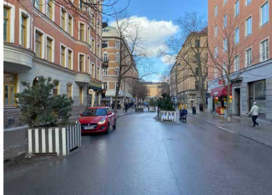
Figur 99: Med hjälp av möbleringen i gaturummet skapas en slalomliknande rörelse för fordon som ska röra sig längs Swedenborgsgatan. Möbleringen hjälper till att smälta av det breda gaturummet för att hålla nere hastigheten.
