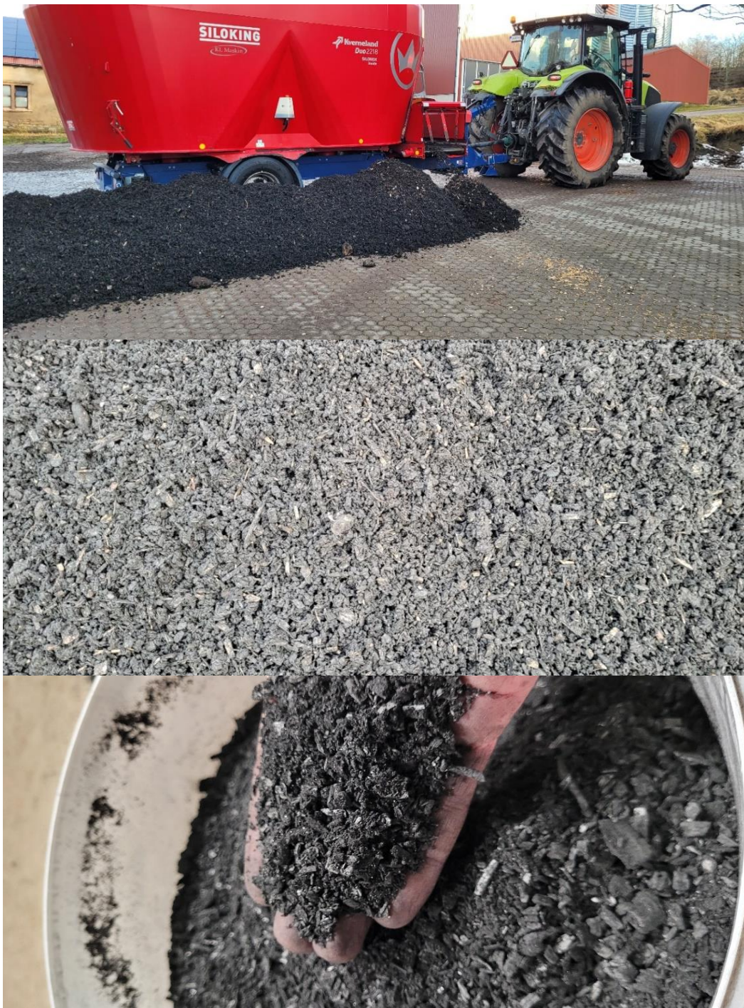
Figur 2. Bilder från försök med avloppsslam/träflis-blandning på Hjelsäters egendom 2024. Uppifrån och ner: Utmatning av avloppsslam/träflisblandning från mixervagn, torkad blandning och blandbiokol. Foto Edvard Hamilton.
