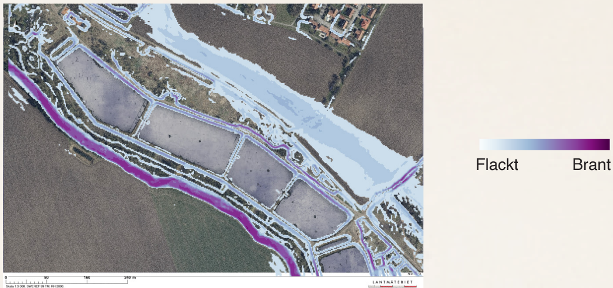
Fig 21. Lunds reningsverksdammar. Satellitbildsunderlag där lutningar brantare 10% givits ett färgintervall där ljusblå är 10% och ju djupare färg desto brantare lutning. Där satelitbilden syns igenom gäller alltså lutningar mindre än 10%. Här syns tydligt att lutningen direkt runt om själva vattenspegeln är brantare än 10% och detta exempel får i datan alltså ett värde av "frånvaro av lutning under 10%". Flygbild Min Karta © Lantmäteriet.
