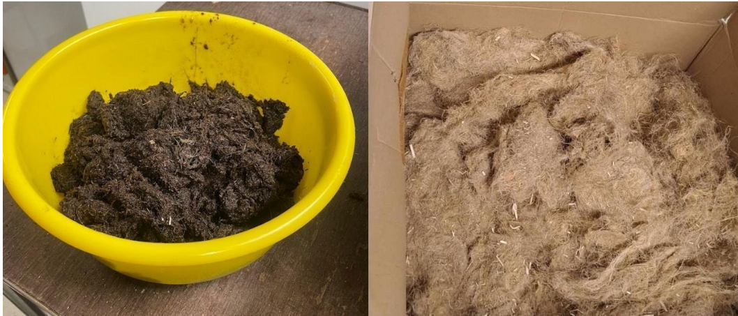
Figur 3. Från vänster till höger; 50/50-blandning av industrihampa och torv, lösullsisolering innan sönderdelning.
