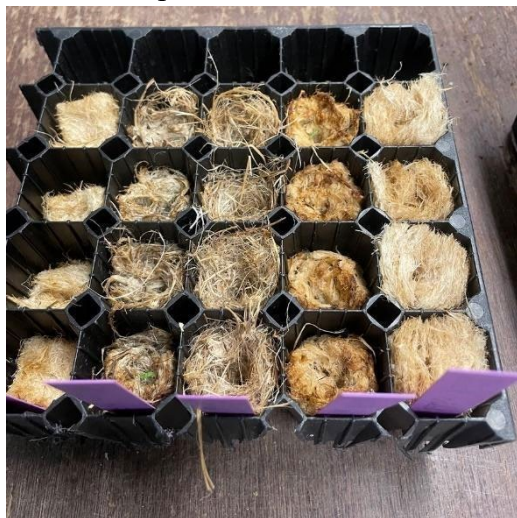
Figur 1. Substrat som ingick i den inledande testodlingen. Från vänster till höger; Industrihampaisolering lagd vågrätt i kasset, lösullsisolering grovhackad, lösullsisolering, industrihampaisolering grovhackad, industrihampaisolering lagd lodrätt i kasset.
