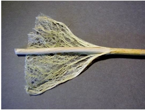
Figur 2. Uppskuren stam från industrihampa med synliga fibrer i de yttre delarna.
