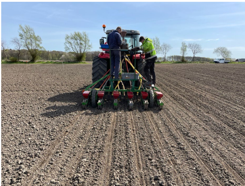
Figur 3. Den specialbyggda såmaskinen. Det är två utsädesbillor för servicegrödorna mellan såhusen för sockerbetsfröna. Foto: Carl-Hugo Jonsson
