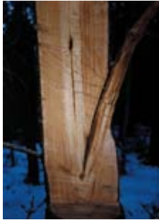
Figur 6. En sprötkvist leder till försvagning och kvalitetssänkning av timret.
