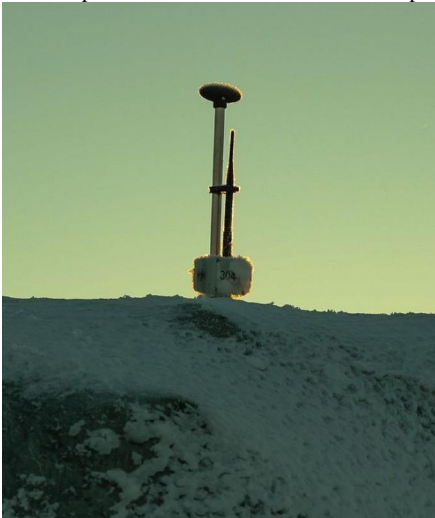
Figur 9: Temperaturspjut nedstucket en och en halv meter ner från toppen av en stuka. Foto: Rikard Andersson
