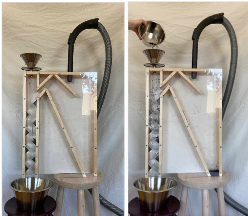
T.v. Bild på den hemmabyggda fröseparatorn (The Real Seed Collection Ltd u.å.). T.h. Pågående separering.
