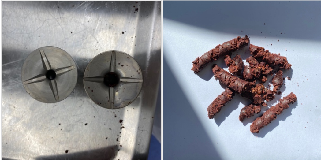
Figur 10. T.v. Mottryckskomponenter, den vänstra med mindre hål respektive högra med större. T.h. Den torra presskakan som kom ur oljepressen (genom hålet i mottryckskomponenten) när Rondo pressades, innan den pressats på nytt.
