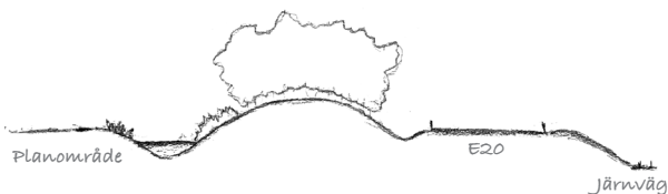
Sektion D – D. Dagvattendamm med högvuxet gräs och vass, en tätare trädunge på bullervallen samt högvuxen gräslikande vegetation i diket längs med vägen.
