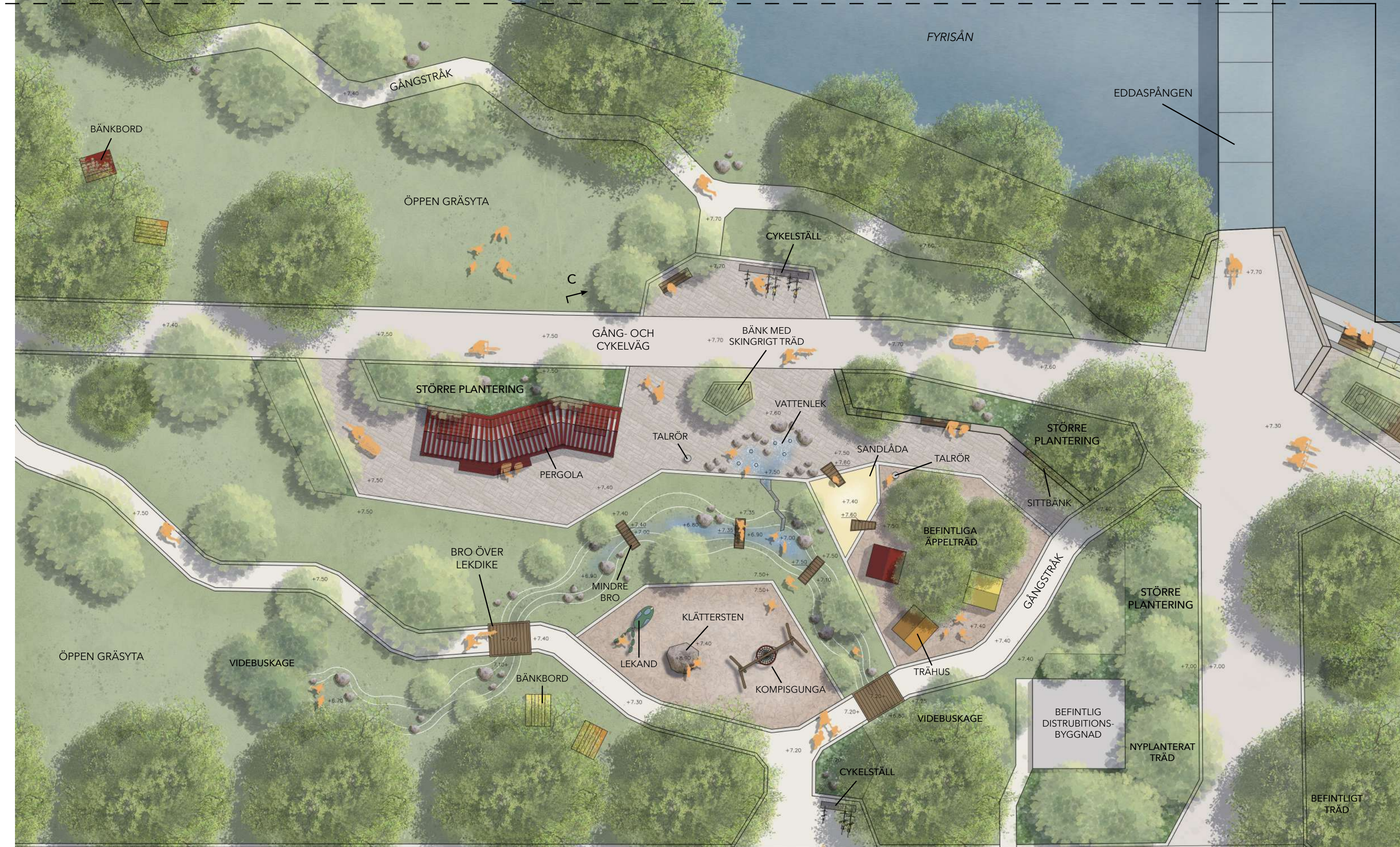
FIGUR 72 // Inzoomningen visar lekmiljöns ingående delar; bland annat den röda pergolan, det slingrande lekdiket och småhusens placering i relation till de befintliga äppelträden. Skala 1:200 (A3).
