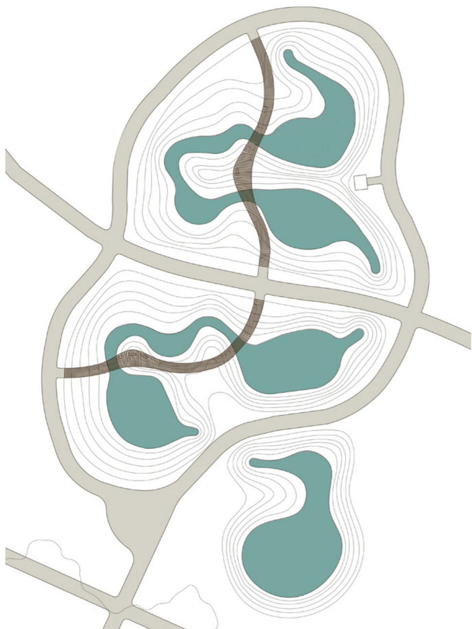
Figur 49. Vattennivån vid normala flöden, vattenyta ligger på cirka +4.4 meter över havet.
