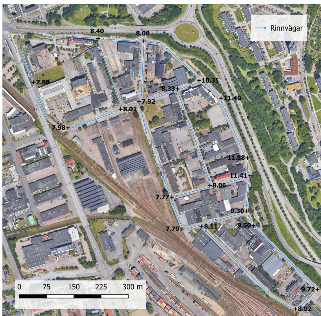
Figur 15. Pilarna visar vattnets naturliga rinnvägar på de befintliga vägarna i Gåsebäck samt en enklare höjdsättning från Scalgo (2024). Kartan är skapad i QGIS.
