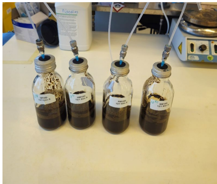
Figur 18 Fyra flaskor fyllda med ca 100 ml substrat och tre replikat av samma art, flushas genom att varva utpumpning av luft och inpumpning av kvävgas.
