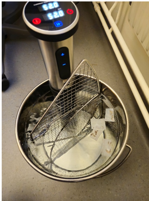
Figur 21 Tre upprepningar av samma art placerades i ett vattenbad. Vattenbadets temperatur uppnåddes med hjälp av en sous vide placerad i en hink med ca 8 liter vatten. Gallret var till för undvika att fröna skulle fastna eller sugas in i apparaten. Foto: Elin Strömberg
