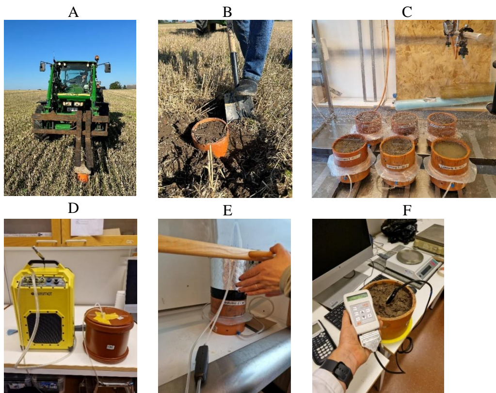
Figur 19: Lysimetern pressades ned i marken (A). Lysimetern med ostört jordmaterial grävdes fram (B). Lysimetrarna utsattes för regnsimulering (C). GASMET GT5000 TERRA som mätte koncentration av växthusgaserna i luften ovanpå lysimetern (D). Flöden av växthusgaser mättes i ett dragskåp (E). Vattenhalt och EC mättes i lysimeterns översta lager efter två regnsimuleringar (F). Foto: Jens Blomquist (A och B), Jakob Larsson (C-F).
