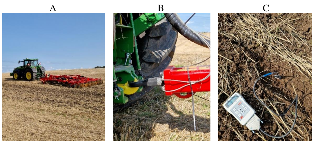
Figur 20: Dragkraftsmätning i fält (A). Dragöglan utrustad med töjningsgivare (B). Mätning av vattenhalt och EC på bearbetningsdjupet (C). Foto: Jakob Larsson.
