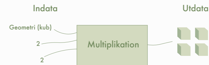
Figur 26. En komponent med numeriska värden, geometri som indata och fyra kuber som utdata.
