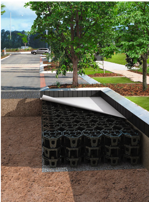
Figur 8. Produktbild StrataCell™, som är ett exempel på ett rotcellsystem. Hållrummen i plastmodulerna fylls med jord och låter trädrötterna växa in i systemet. Systemet är vikt bärande och täcks med markbeläggning (Milford 2024).
