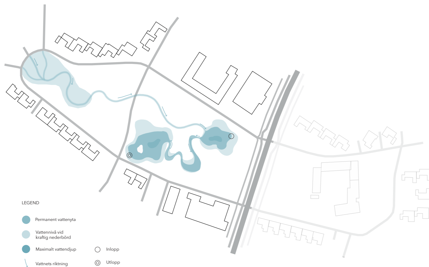
Figur 65: Plan över Videdalsparkens nya vattenmagasineringsystem vid olika vattenmängder.
