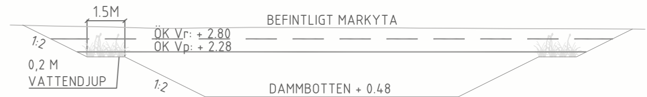
Figur 24. Sektion A-A över fördamm (WSP 2022e). Sektionen är markerad i översiktsskissen på föregående sida. Skala 1:150/ A3.
