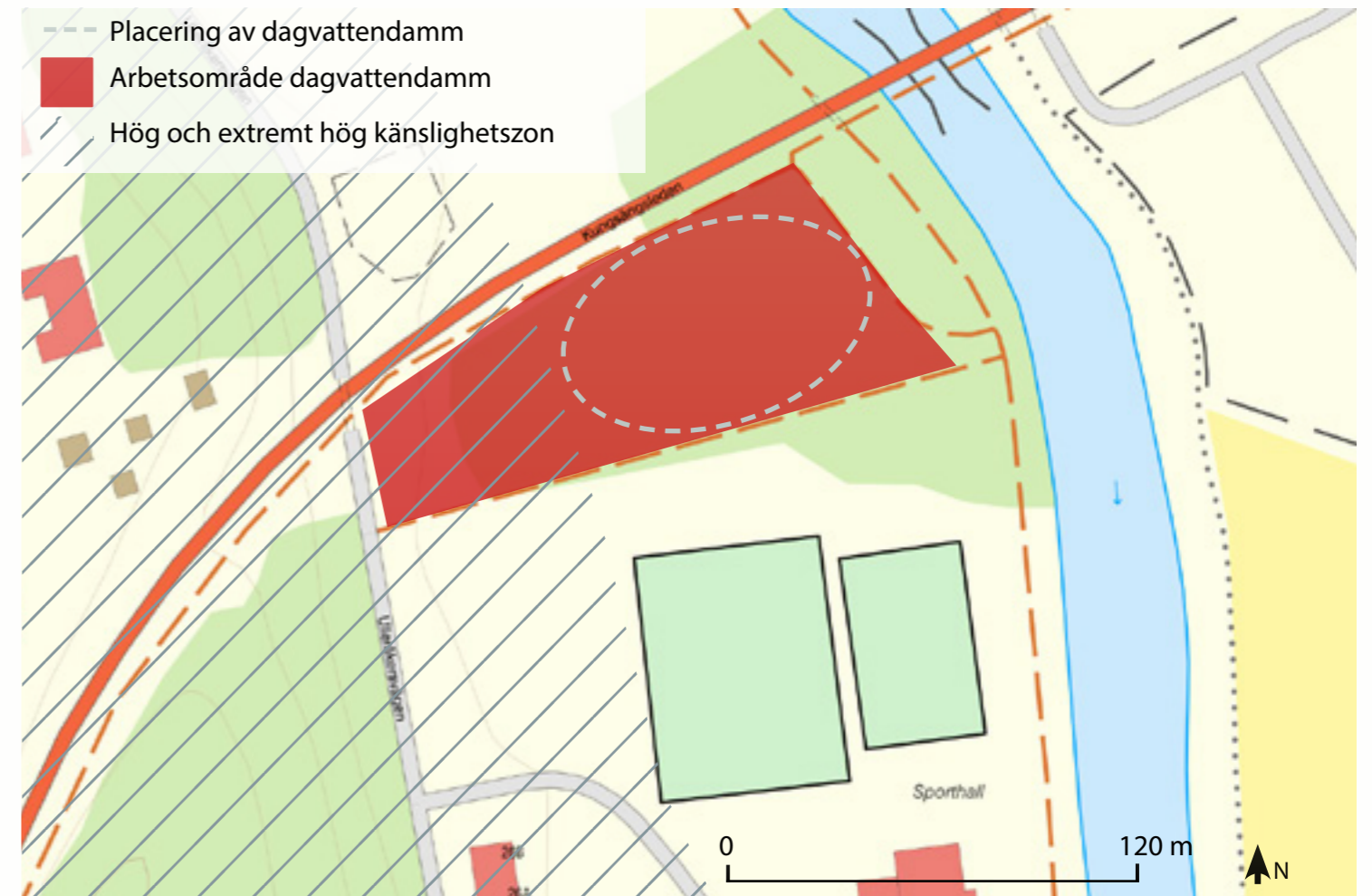
Figur 22. Kartan visar gränsen för extremt hög känslighetszon. Dammen placeras utanför den extremt höga känslighetszonen. Bearbetad karta från © Lantmäteriet. Skala 1:2000/ A3.
