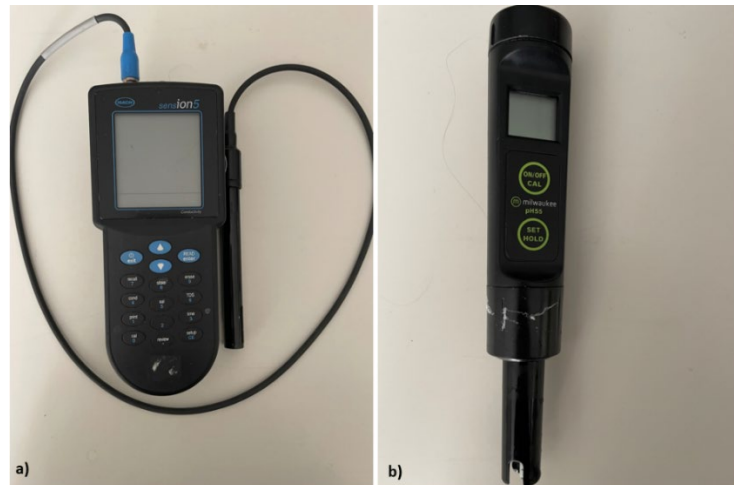
Figur 5. Figuren visar konduktivitetsmätaren och pH-mätaren som användes i försöket. a) Sension5, Hach b) pH55, Milwaukee.
