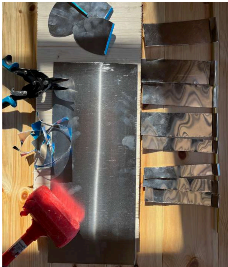
Figur 76. Aluminiumplåt valdes för undersökningen på grund av sin lätta men stabila form. Vi kunde också forma den genom att klippa i den med en metallsax. En undersökning av olika former och dimensioner på plåten samt en varierande upphängningen testades.
