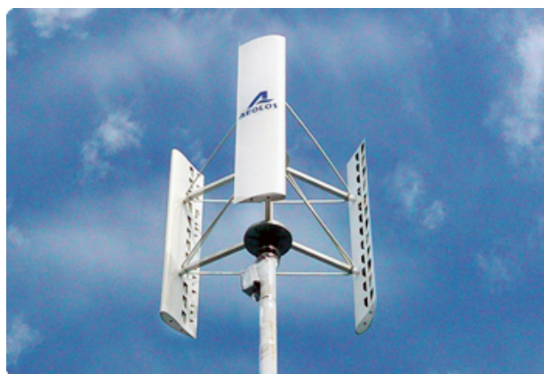
Figur 5: Exempel på en VAWT[19] föreställande en H-rotor.
