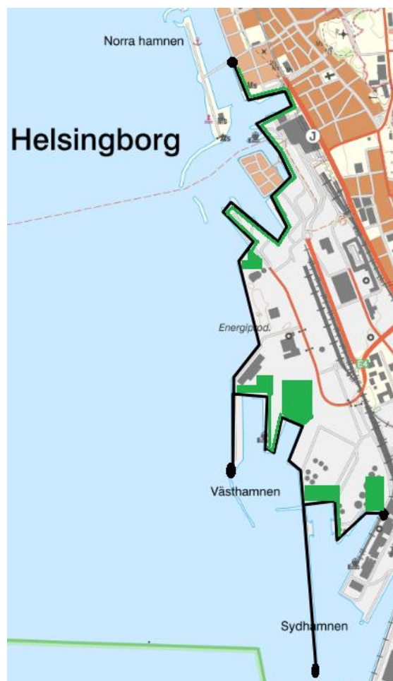
Figur 3. Karta över dagens tre hamnområden (Norra-, Väst- och Sydhamnen) där den svarta linjen är upphöjda skyddsstrukturer, och de gröna områdena är tilltänkta gröonstrukturer (© Lantmäteriet, 2023b, illustration Alexander Larsson)
