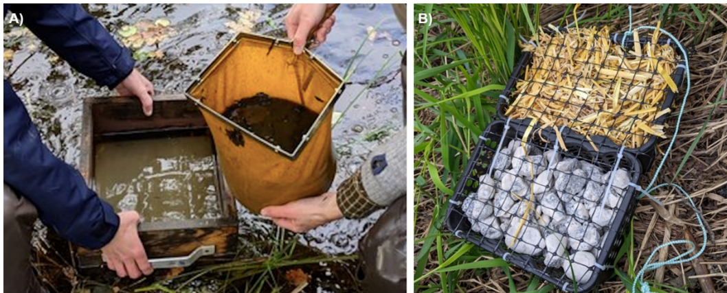
Figur 2. A) Bild på insamlingsmetod med kick-net. B) Bild på insamlingsmetod med specialgjord fälla, där halm och sten använts.
