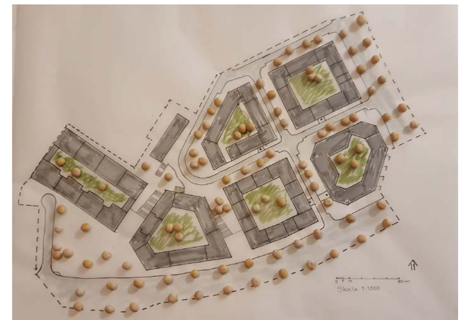
Figur 39: Skiss tre med cirka 95 träd inom planområdet vilket ger en krontäckningsgrad på cirka 9%. Träd i gatumiljö har ett ungefärligt c-c på 15 meter.
