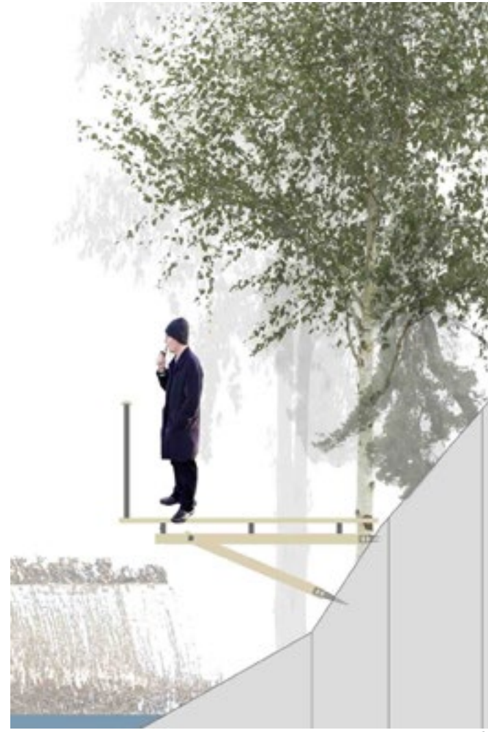
D Skala 1:50 A3 Figur 132. Snitt D Med konsolbryggan kan besökare nu röra sig längs strandlinjen.
