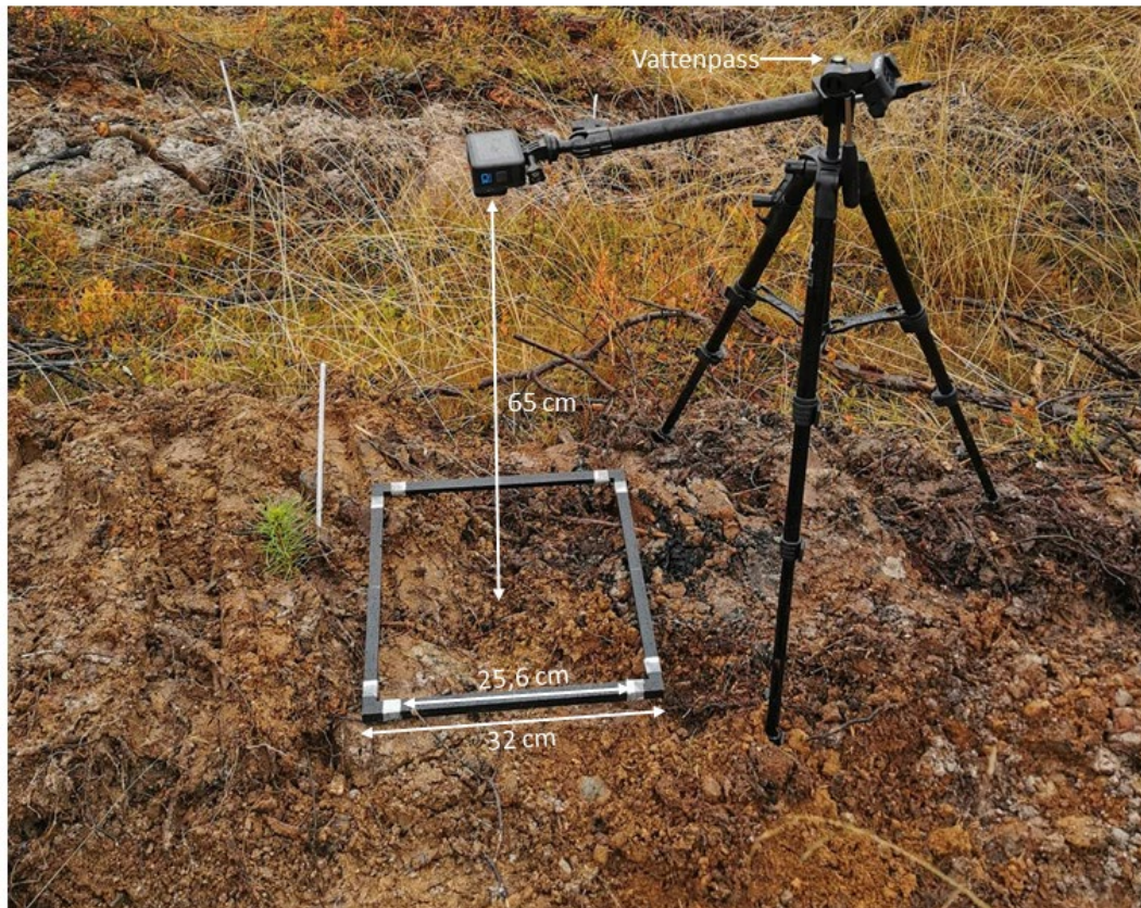
Figur 3. Uppställning av utrustning för insamling av bilder på provytorna (Foto: Alice Kårehagen). Figure 3. Setup of equipment for collecting photos of the sample spots (Photo: Alice Kårehagen).
