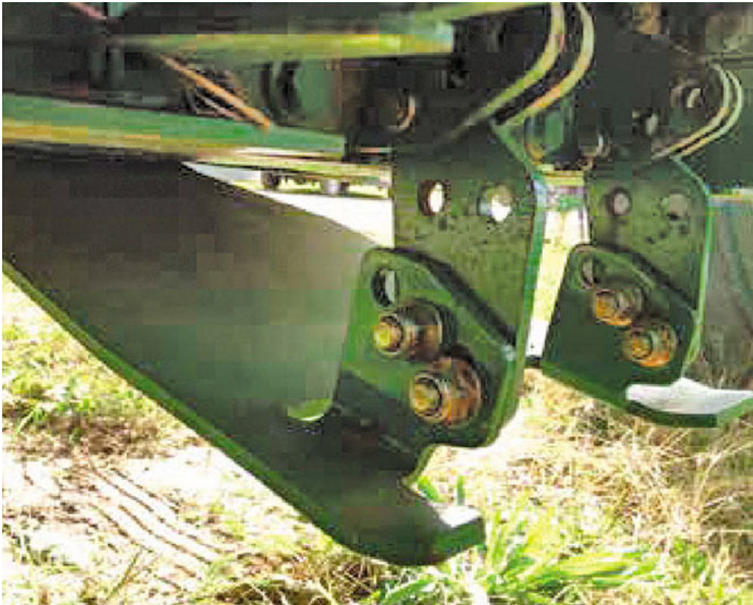
Figur 7. Justerbara släpskor för ökad stubbhöjd vid skörd av vall. (Keyser u.å.a)
