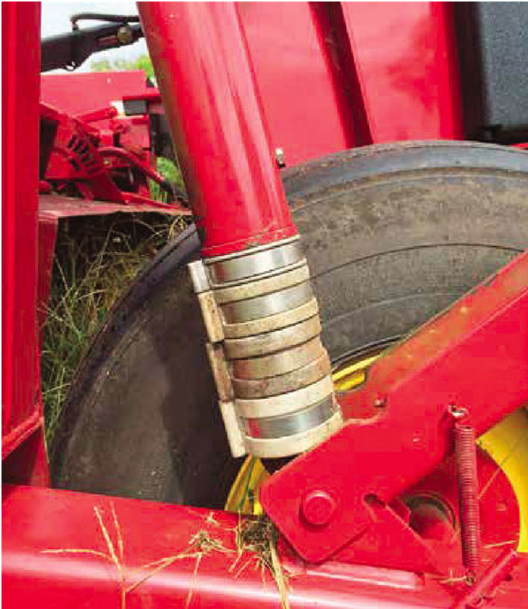
Figur 8. Slagbegränsade distanser monterade på bogserad slåttermaskins kolvstång för ökad stubbhöjd vid skörd av vall. (Keyser u.å.b)
