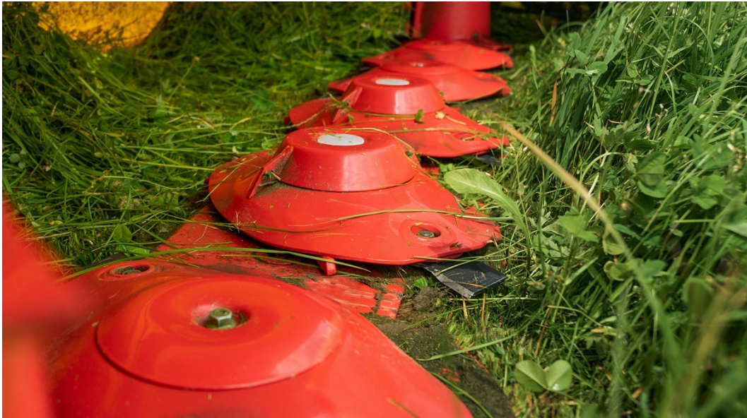
Figur 3. Slåtterbalk. (Pöttinger Landtechnik GmbH u.å.c)
