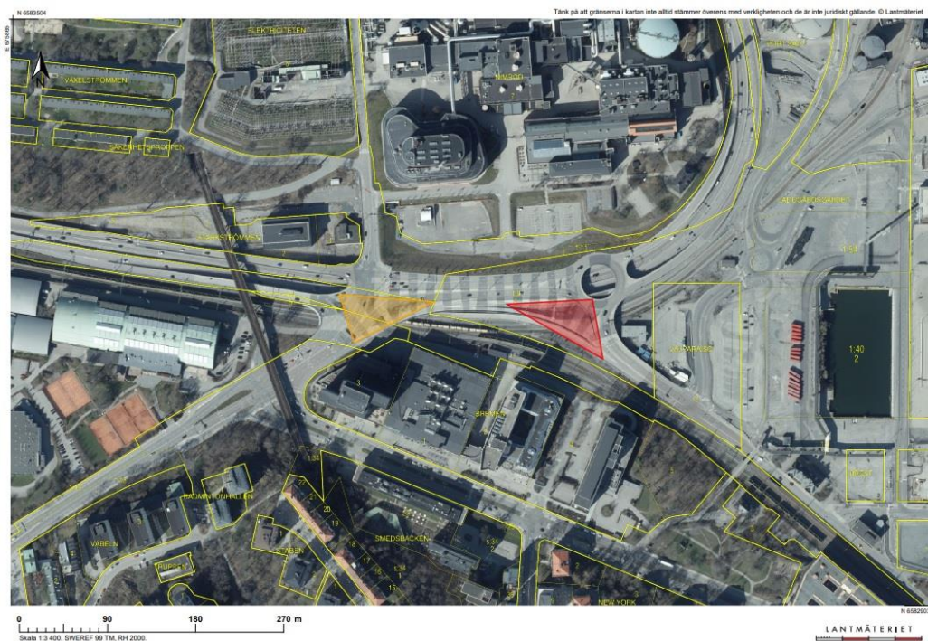
Figur 3, Lidingövägen och Norra länken i Stockholm © Lantmäteriet. I figuren är växtbäddarnas placering markerade; orange är växtbäddar med StrataCeller och röd växtbäddar av skelettjord.
