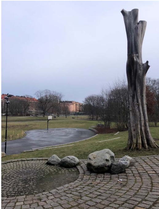
Figur 10. I förgrunden finns en cirkulär nedsänkning där vattnet fördröjs innan det fortsätter ned till den skålade gräsytan och aktivitetsytan. Detta kan fungera som ett fågelbad eller tillsammans med omgivande stenar som ett lekelement. Till höger finns högstubben med klättergrepp och i bakgrunden ser man aktivitetsytan. Fotografi: Magnusson 2023
