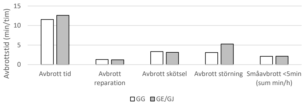
Figur 9. Totala avbrottstid för GG- respektive GE/GJ-aptering. Avbrottstiden för reparation, skötsel, störningar och den sammanlagda summan av småavbrott mindre än 5 minuter är också redovisad. Värdena är inte viktade och inkluderar trakter avverkade mellan 2021-01-01 och 2022-08-31.
