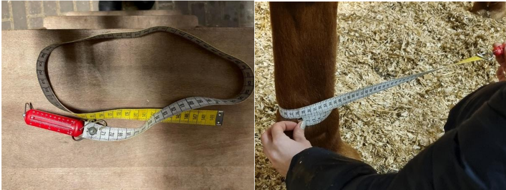
Figur 5. Måttband lades runt skenbenet (kotsenskidan och kotleden). Vid mätningen användes måttbandets millimetergradering som sträcktes till 0,1 kg (1N).
