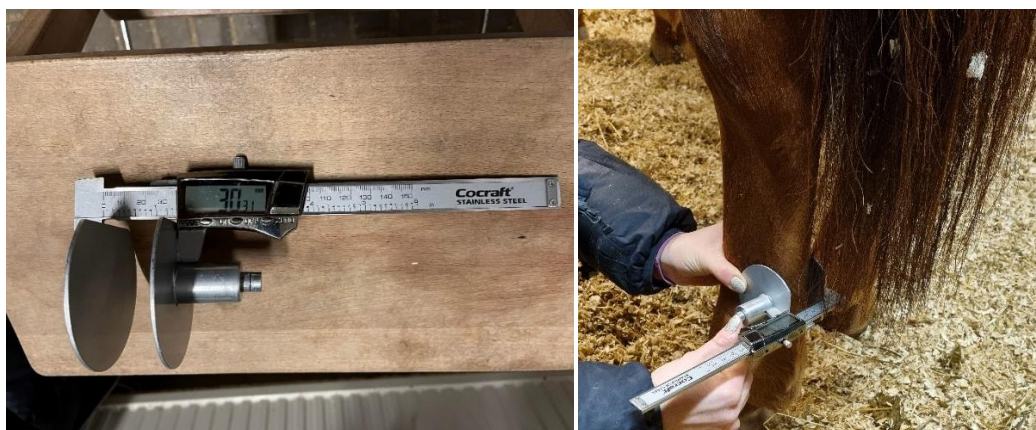
Figur 4. Skjutmått lades an mot skenbenet (kotsenskidan och kotleden) både lateralt och medialt och sedan fördes en knapp in för att skapa ett konstant tryck. Måttet kom upp på skärmen.
