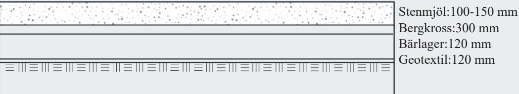
Figur 49. Överbyggnaden vid användning av stenmjöl bör ha ett slitlager på 10-15 cm för att sladdning med maskin ska kunna ske. Detta är en önskvärd utformning utifrån en skötselperspektiv då sladdning ger en mer rationell skötsel. Enligt Arkitektens handbok upl. 2021, visas ett exempel på 30 mm bergkross 0-16 mm under slitlagret och sedan ett bärlager på 120 mm på en geotextil.
