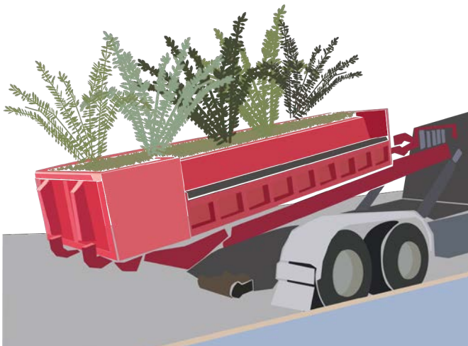
Figur 5. Containrarna förflyttas med hjälp av flakväxlare.
