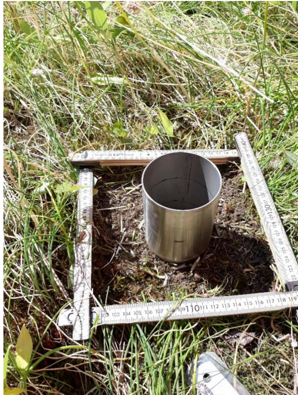
Figur 4. Provtagning med metallcylinder. Foto: Green Roof Aging Project.
