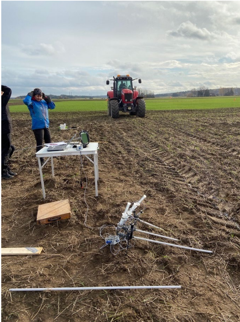
Figur 4. Körning i ett försöksled, bollingsonderna sitter på 20, 40 respektive 60 cm djup under centrumlinjen av hjulspåret. Mätdata registreras i datorn på bordet.
