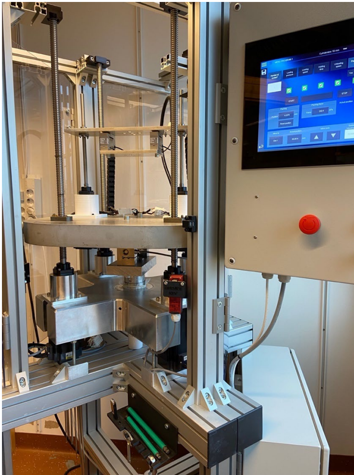
Figur 3. Maskinen där proverna komprimeras till förinställd belastning.
