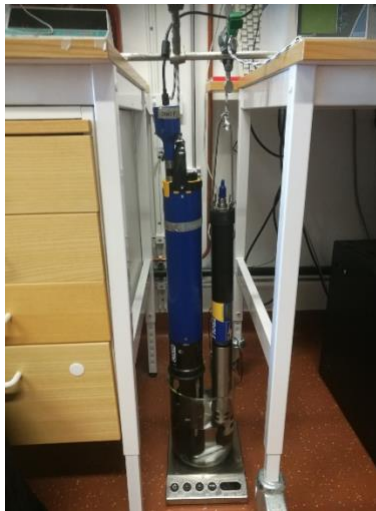
Figur 4. Labbutrustning och labbuppsättning, sensorerna hängdes upp och placerades i en bägare.
