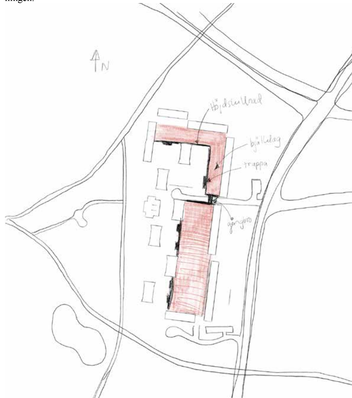
Figur 17. Bjälklagets utsträckning, höjder och trappor .
