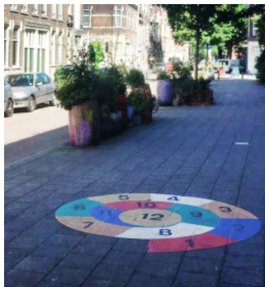
Figur 4. Ett fotografi från Rotterdam i Nederländerna där de har valt att bredda trottoaren för att ge mer utrymme för gångtrafikanter. Fotot visar hur man har separerat trafiken med växtlighet och tillsatt enkla medel med illustrationer på marken för att öka barns nyfikenhet och kreativitet. (Gill, 2021) Används med tillstånd.
