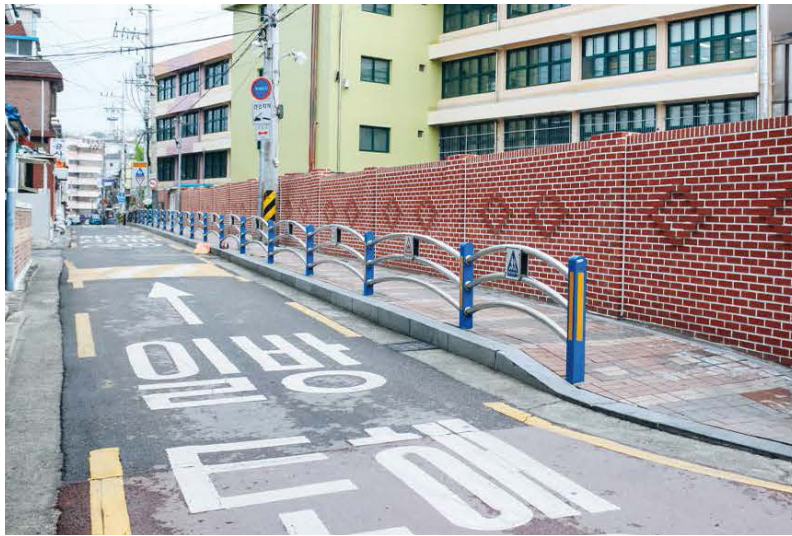
Figur 5. Punktinsats i Sydkorea. Fotografiet visar hur de i en stad i Sydkorea med en punktinsats försökt förbättra trafiksituationen för barnen i en skolzon. Här använder de staket längst väggkanten för att bilar inte ska parkera längst gatan, vilka skymmer den fria sikten. (NACTO & GDICI, 2019) Används med tillstånd.
