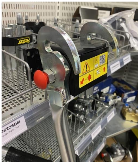
Figur 10. Kopplingsplatta av fabrikatet Faster, med tillhörande handgrepp som kopplar ihop och isär nippelplattan.
