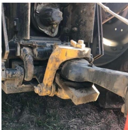
Figur 8. Kuldrag med fjäderbelastad låsning av märket Dromone.
