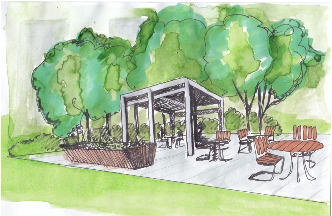
Figur 24: I pergolan finns det möjlighet att sitta ner och äta eller fika vid utplacerade bord och stolar. Här finns även upphöjda, snedfasade växtbäddar, som gör det möjligt för rullstolsburna att komma nära växterna. Markmaterialet vid pergolan består av grå betongsten som ger en bra framkomlighet då de inte blir hala vid väta. Illustration Isabella von Platen.
