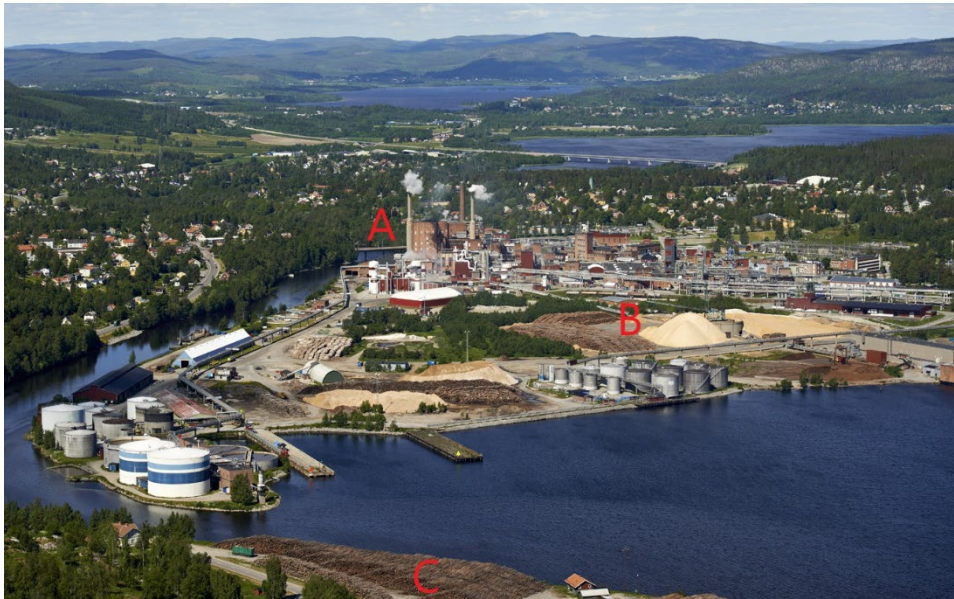
Figur 1. Industrispecifik virkesterminal i direkt anslutning till industrin. A: industri, B: industrispecifik virkesterminal, fortsätter även med till vänster i bild där det finns fler virkestravar och flishögar, C: virkesterminal som fungerar som lagringsplats för längre perioder och/eller för att lastas om till båt. Foto: Domsjö Fabriker.
