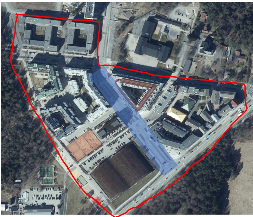
Figur 2. Områdesbild över Rosendal Etapp 1. Den transparenta blå ytan är den yta som hänvisas till vid beskrivning av kolmakadamfyllda förstärkningslager under gata. Illustration: Marlene Nilsson © Lantmäteriet
