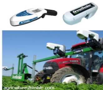
Figur 7: En bild på hur en GreenSeeker ser ut. Kan antingen vara handhållen eller vara monterad på traktorn (CropScan, 2018).
