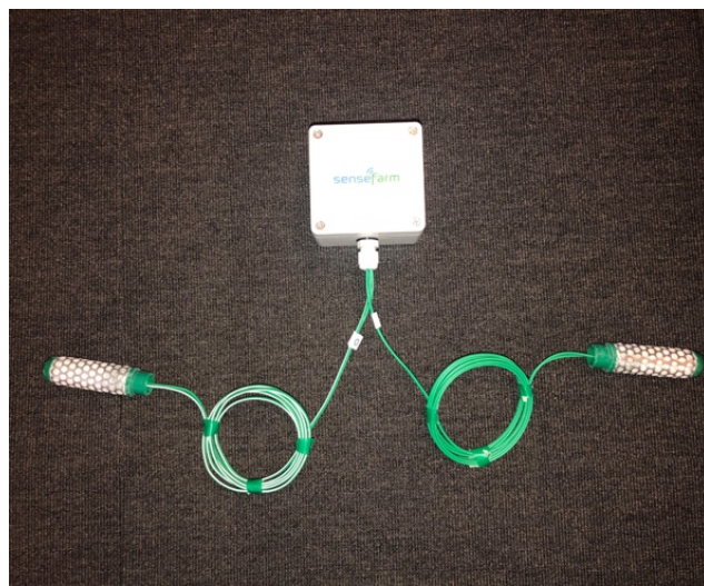
Figur 3. Fuktsensor som används i Helsingborg. Två fuktgivare är kabelanslutna till en dosa innehållande batteri och kretskort. (Foto: Andréas Hall, publicerat med tillstånd av fotografen 2022-02-25).
