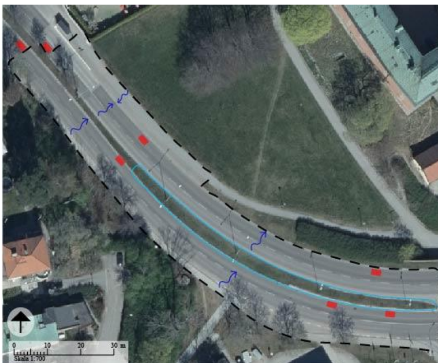
Figur 16: Flygbild över Västra ringvägen med avrinningsområde (streckat), mittrefug (ljusblå markering), brunnar (röda rektanglar) och tvärfall markerat (blåa pilar). © Lantmäteriet, 2021.
