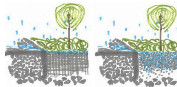
Figur 18. Jämförelse av infiltration i växtbädd med planteringsjord (t.v.) kontra bädd med biokol, makadam och kompost (t.h.).
