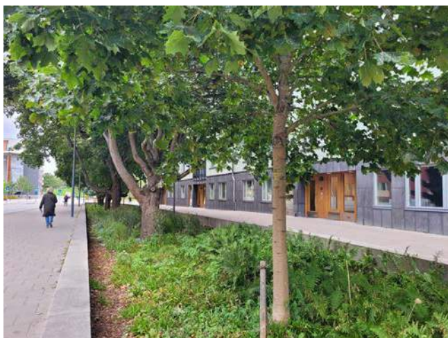
Figur 20. Nedsänkta växtbäddar som strategi för att bevara befintliga träd.
